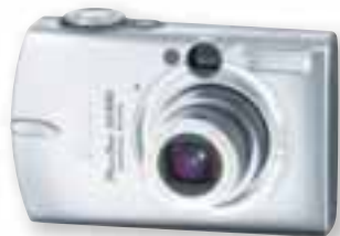
Arriba: El campo de visión del objetivo de las cámaras digitales es inferior al de las cámaras de 35 mm.
