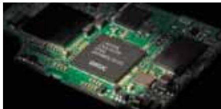
Arriba: Un procesador de señales digitales DIGIC II
